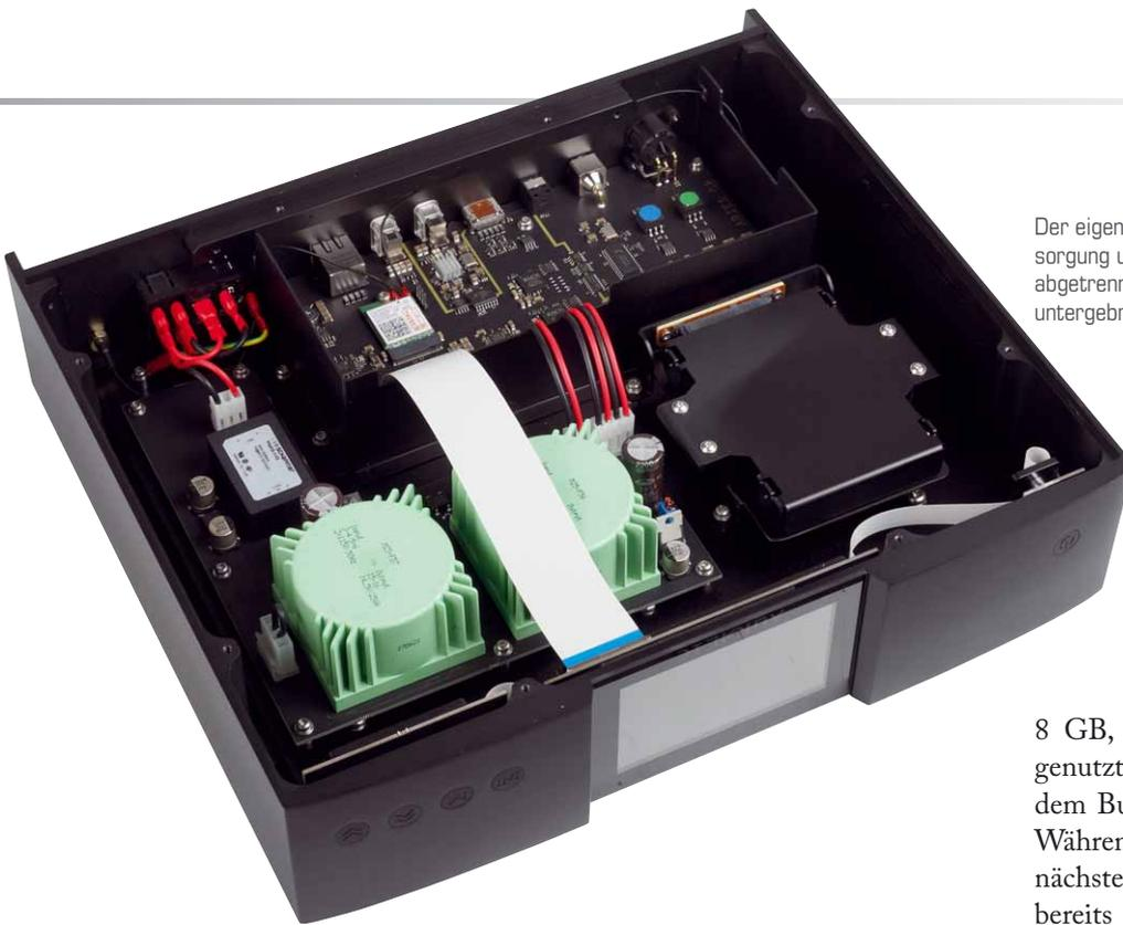
Der eigentliche Streamer ist von der Stromversorgung und dem Steckplatz für die Festplatte abgetrennt im hinteren Gehäusebereich untergebracht
