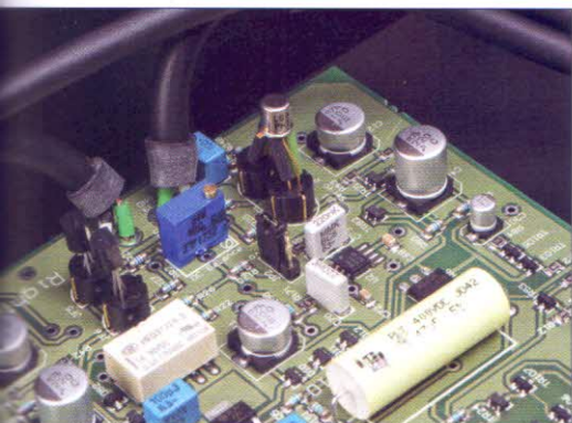
Hier erkennt man die extrem rausch- armen Eingangs-Feldeffekttransistoren
