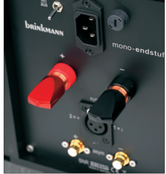
Schlicht, aber edel: erstklassige Lautsprecherklemmen an den Monos, darunter RCA- und XLR-Eingänge – fertig.
